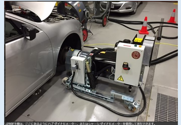
J2908手順は、ここにあるようにハブダイナモメーター、またはシャフトダイナモメーターを使用して実行できます。
